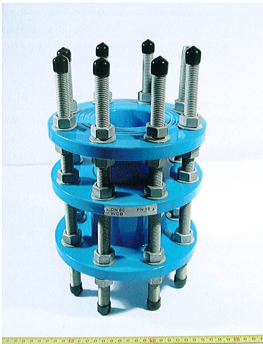
Figura 1 – Giunto di smontaggio a tre flange in acciaio – Campione come pervenuto
